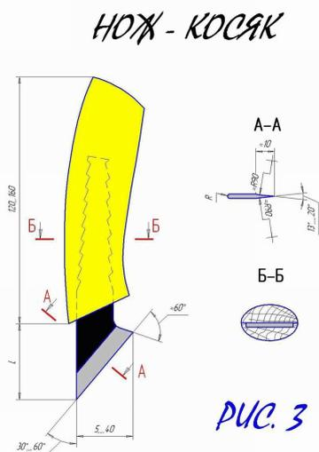
Название произошло оттого, что нож имеет скошенный клинок. Ну не в этом суть: Нож применяется для прорезания материала, нарезки шпона, подрезки контуров, различных видов резьбы, типа плоскорельефной геометрической резьбе, кудринской и т.п. Ещё этот нож называют сапожным но, на сколько смог выяснить, сапожный нож отличается односторонней (стамесочной) заточкой клинка. Хотя и не всегда.
